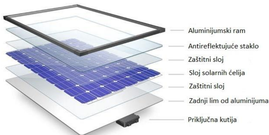
Slika br.2. Tipična konstrukcija solarnog panela
