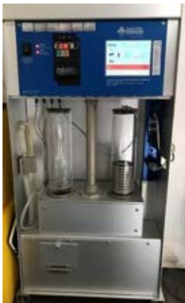
Слика 44. Гравиметријски узоркивач чврстих честица TSP, PM 10 и PM 2.5
