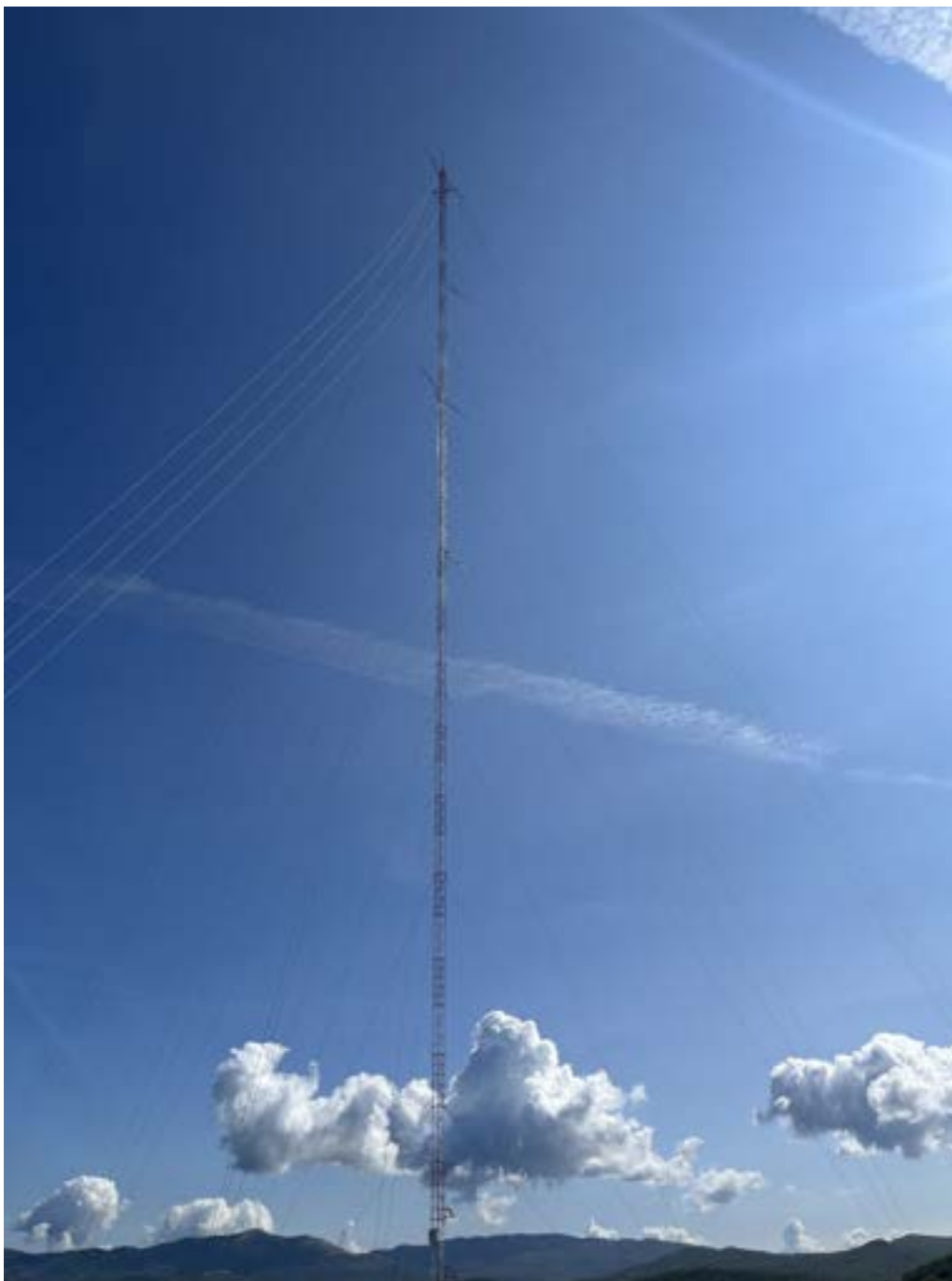
Слика 15. Мјерни стуб за мјерење брзине вјетра на локацији Планик.
