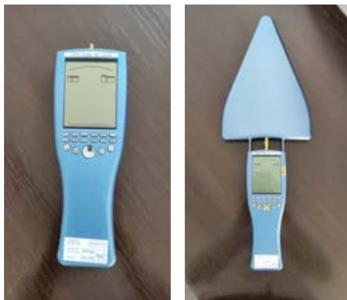
Слика 48. Анализатор спектра са антеном.
